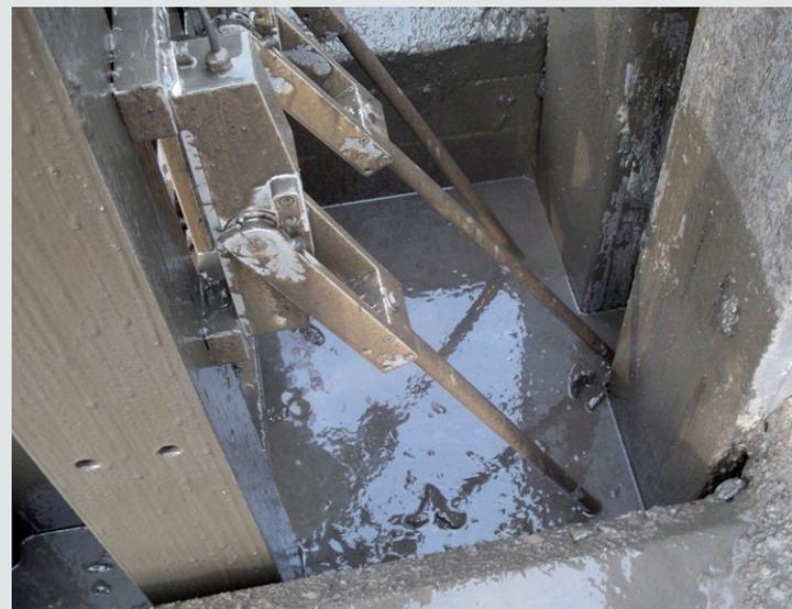
Die Fugenvermessung erfolgt über ein mechanisches Messverfahren, das auf die Schlitzbreite und den Fugentyp eingestellt wird.
